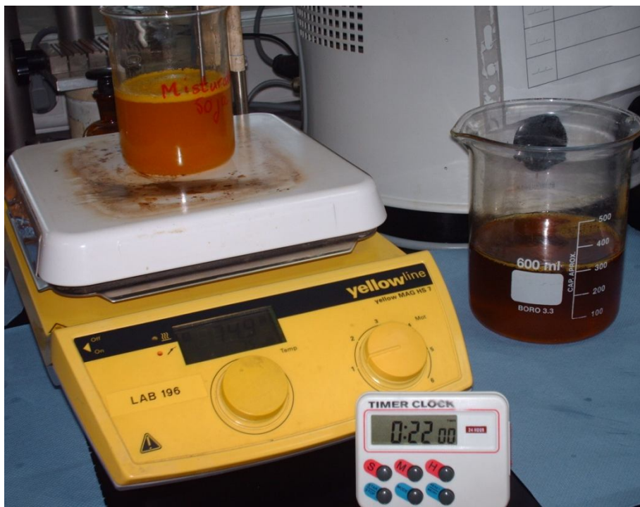
Figura 45 - Etapa de aglomeração (óleo de soja), na qual se observa a acumulação de aglomerados na superfície do óleo. Este apresenta já nesta etapa uma tonalidade mais clara do que o óleo desgomado inicial (recipiente da direita)
