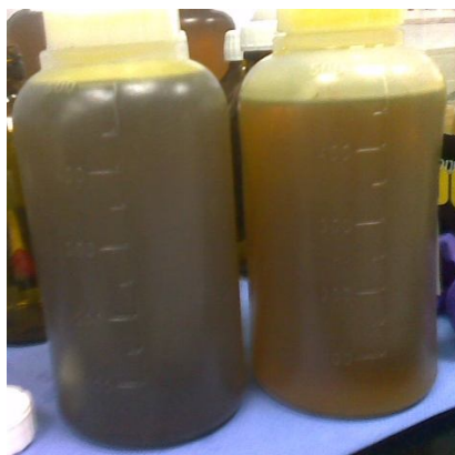
Figura 11 - O efeito da remoção de fosfatídeos e outras impurezas durante o processo manifesta-se na coloração do óleo. À esquerda uma amostra de óleo de soja bruto e à direita uma amostra de óleo desgomado fisicamente, ambas recolhidas na fábrica
