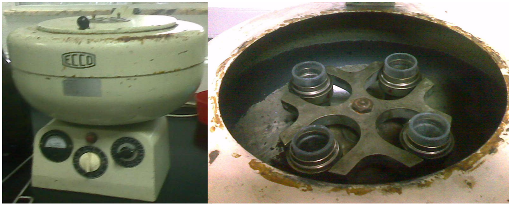
Figura 17 - Centrifuga utilizada no laboratório (esquerda) e vista dos seus quatro copos (direita)
